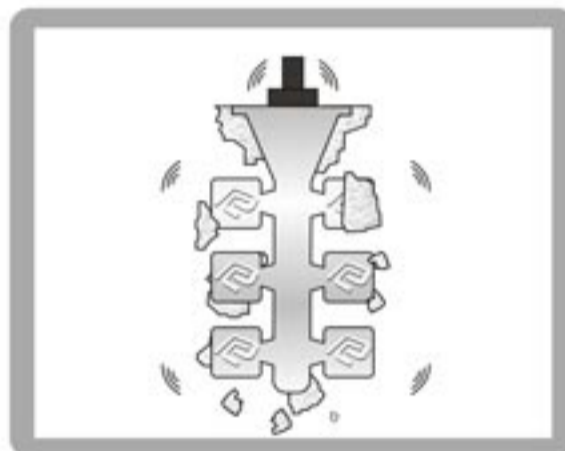
08 - Remoção da casca cerâmica Ceramic shell removal Remoción de la cáscara cerámica Entfernen der keramischen Schale
